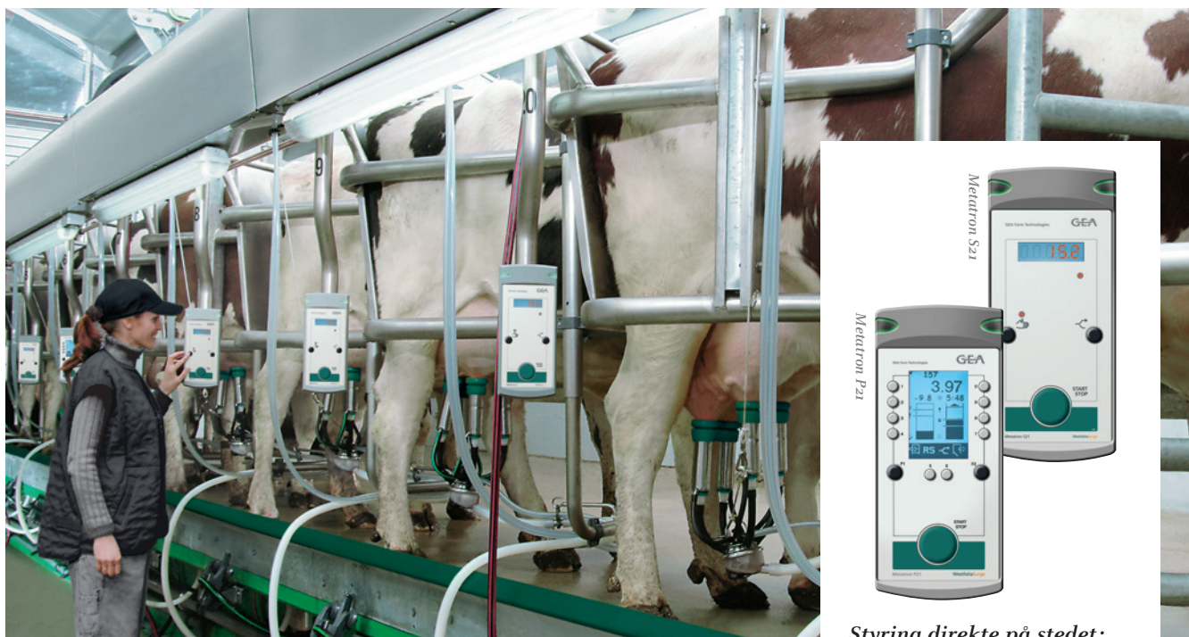
Styring direkte på stedet: Metatron P21 / S21 - den „lille PC i malkeanlægget”
